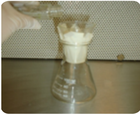
شکل ۹- عبور محیط حاوی بساک‌های متلاشی شده از صافی به منظور جداسازی میکروسپورها
